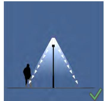
Aufsatzleuchte mit Lichtlenkung
